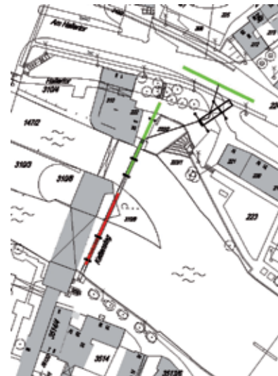
Prinzipskizze: Verschub der Hohlkästen durch Rollen auf Bestandskonstruktion.
