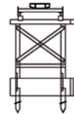
Prinzipskizze: Verschub der Hohlkästen durch Rollen auf Bestandskonstruktion.
